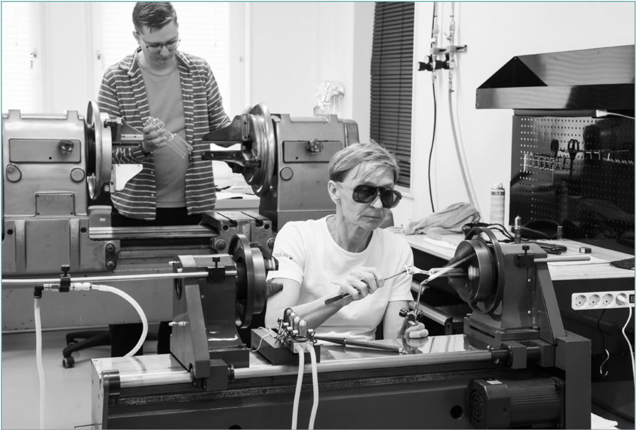
Ett viktigt moment i tillverkningen av röntgenrör är teknisk glasbläsning. I glassvarvna läggs glas på metall (kovar) och glaskroppen formas till önskad längd och form.
